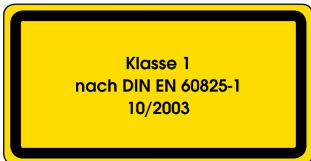
Lasereinrichtungen der Klassen 2 bis 4 müssen nach Abschnitt 5.8 EN 60825-1 auf einem Hinweisschild durch Angaben über die maximalen Ausgangswerte der Laserstrahlung, der Impulsdauer (falls zutreffend) und der ausgesandten Wellenlänge(n) beschrieben werden. Diese Angaben können in einem Hinweisschild zusammen mit der Angabe der Klasse oder in einem separaten Hinweisschild aufgenommen werden.
